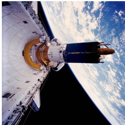
Aussetzen des Tracking Data Relay Satelliten (TDRS) in der Erdumlaufbahn etwa 6 Stunden nach dem Start.
