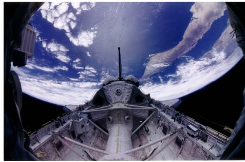
Das Spacelabmodul im Laderaum der Raumfähre Columbia fotografiert von der Besatzung mit einer 35mm „Fischaugen“ Linse über dem Pazifischen Ozean. Im Vordergrund ist der Tunnel zu sehen in dem die Astronauten vom Mitteldeck in das Spacelabmodul schweben.
