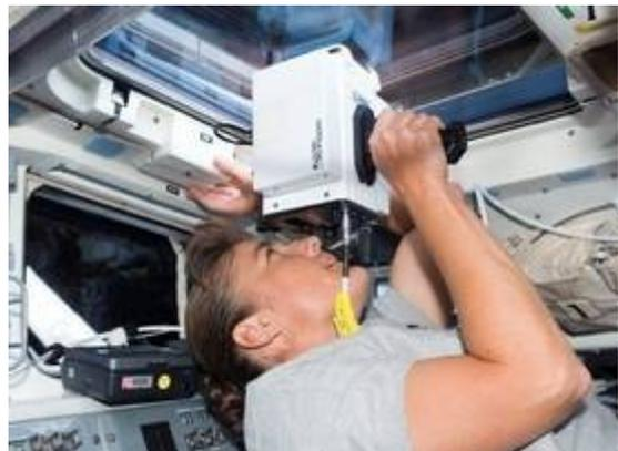
Heidemarie Stefanyshyn-Piper benutzt durch die oberen Fenster des Flugdecks ein Lasergerät zur Messung der Entfernung zur ISS während des Rendezvous der Raumfähre Discovery mit der Internationalen Raumstation.
