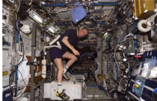
Thomas Reiter, Expedition 13/14 Flugingenieur, trainiert auf dem Fahrrad Ergometer mit einem Vibrations Isolations System (CEVIS) im Destiny Labormodul der ISS.
