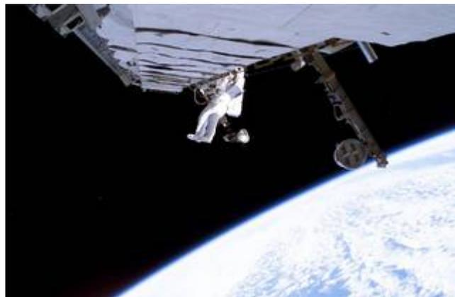
Thomas Reiter arbeitet an einer Kühlleitung im S1 Truss Segment der ISS während seines 5 Stunden und 54 Minuten dauernden Außenbordeinsatzes (EVA) am 3. August 2006.
