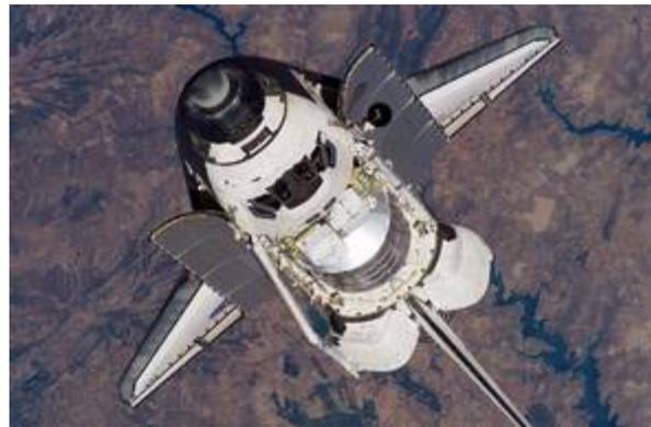
Die Raumfähre Discovery nähert sich der ISS zum Andocken am 6. Juli 2006. Discovery führt eine 360 Grad Rolle für eine Inspektion der Hitzeschutzkacheln durch, die mit einer Serie von Fotos der Astronauten an Bord der ISS dokumentiert wird.
