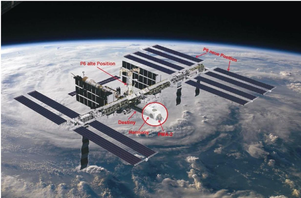
Die Fotomontage zeigt die Konfiguration der ISS vor und nach der Mission STS-120. „Harmony“, mit dem dann bereits montierten Andockstutzen PMA-2, wird an das „Destiny“ Modul installiert. Das P6-Segment, mit zwei eingefahrenen Solarzellenflügeln, wird vom Z1-Gitterelement in der Mitte der Raumstation auf die Backbordseite an das P5-Segment auf seine endgültige Position umgesetzt.
