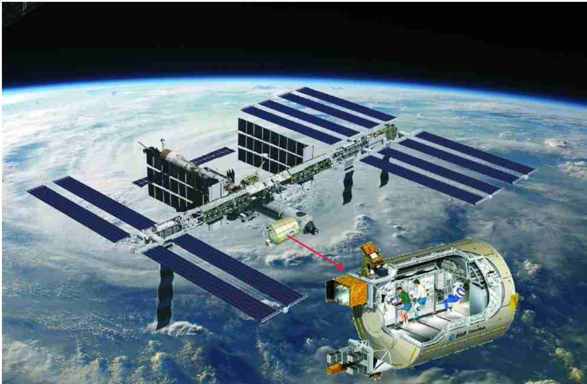
Die Fotomontage zeigt die Konfiguration der ISS während der Mission STS-122. „Columbus“ wird an der Steuerbordseite des „Harmony“ Moduls installiert. Im Vordergrund ein Schnittbild von „Columbus“ vergrößert dargestellt.
