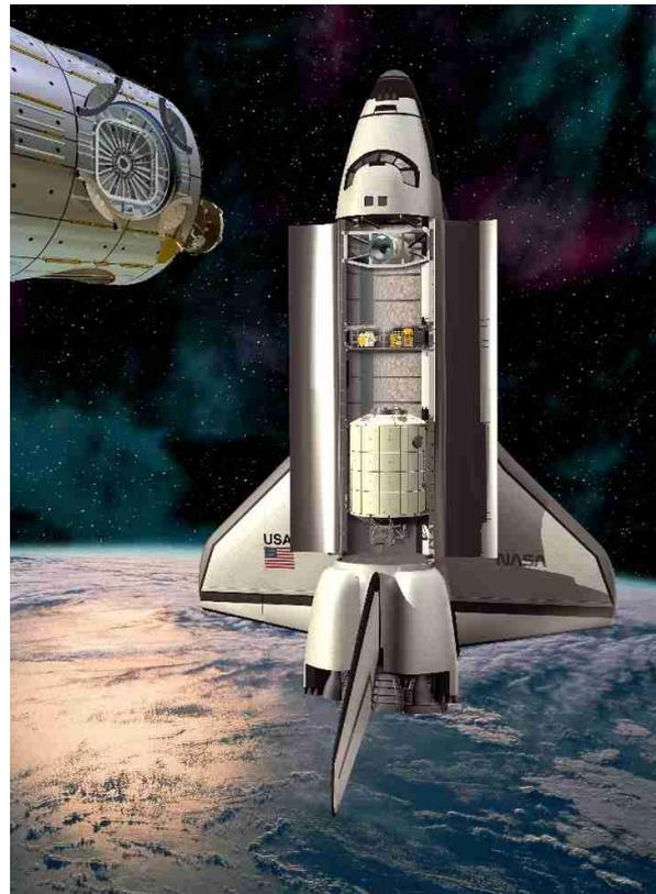
Die Raumfähre Atlantis kurz vor dem Andocken an das Harmony Modul der ISS. In der Ladebucht der Atlantis ist oben das Orbiter Docking System (ODS) installiert, in der Mitte die Palette (ICC-Lite) mit den beiden externen Forschungsplattformen und unten das europäische Forschungslabor „Columbus“ (COF).
