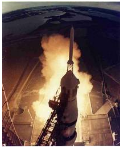
Zündung der 5 F-1 Triebwerke der Saturn V Mondrakete zum Start der Apollo 14 Mission.
