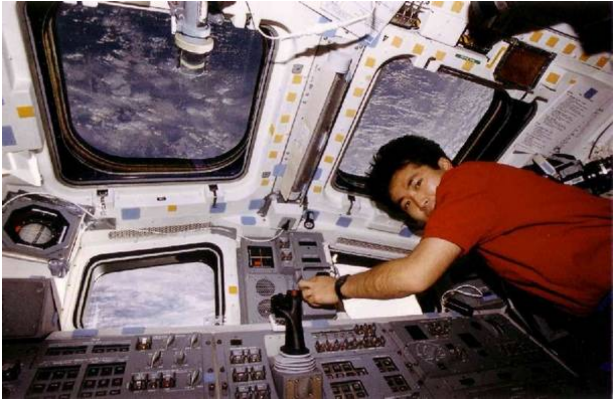
Koichi Wakata bedient während seiner ersten Mission STS-72 den Roboterarm (RMS) im hinteren Flugdeck der Raumfähre Endeavour.
